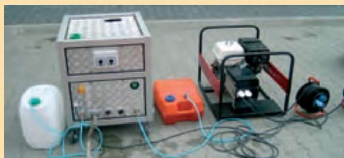
Od lewej: zbiornik na środek odkażający, nagrzewnica wody, zbiornik na paliwo do nagrzewnicy wody, agregat prądowórczy, przedłużacz bębnowy.
